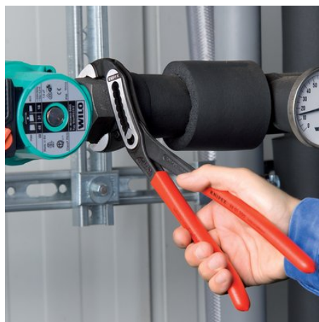
Autobloquante sur tubes et écrous : moins d'effort; l'intégralité de la force appliquée peut être utilisée pour faire tourner la pièce; inutile de trop serrer les poignées de la pince, effort nécessaire réduit
