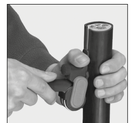
Längsschnitt Longitudinal cut
