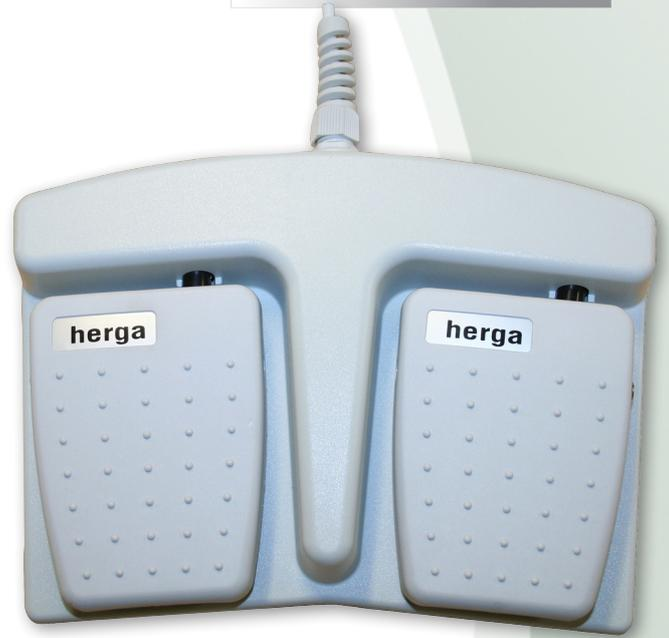
Der zweipedalige USB-Fußschalter vom Typ 6225-0020 ist ausgestattet mit grauen Pedalen und einem grauen Gehäuse. Der USB-Fußschalter ist durch den integrierten DIP-Schalter für den Kunden selbst programmierbar. Der Fußschalter verfügt über ein 2,5m langes Kabel, Schutzart IPX2 und ist zudem ausgelegt für 20mA 5V DC.
