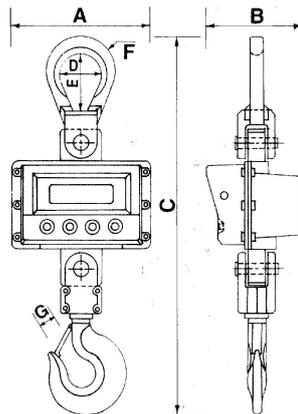
Die KPZ 402 verbindet Zuverlässigkeit, Präzision und einfache Handhabung für härteste Ansprüche in der Industrie, durch Ihre extra für diese Waage konstruierte Wägezelle, dem robustem und massivem Gehäuse, der integrierten Öse und dem Dreh- bzw. Schwinghaken. Die Funktionsdrucktasten sind gut zugänglich, zur einfachen Bedienung aber geschützt ins Gehäuse eingelassen. Trotz Ihrer Robustheit ist die Bauhöhe sehr kurz gehalten, so daß denkbar wenig Hakenhöhe verloren geht.
