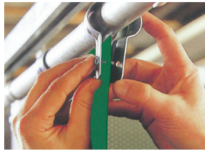
Schnelle und einfache Montage der Lamellenvorhänge. Die Lamellen werden vorgelocht geliefert. Schwingschellen vermeiden Biegeverschleiß der Lamellen.
