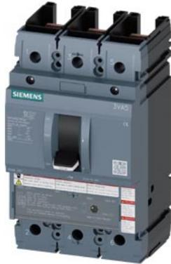
Leistungsschalter 3VA5 UL Frame 250 Schaltvermögenklasse M 35kA @ 480V 3-polig, Anlagenschutz TM230, FTAM, In=150A Überlastschutz Ir=150A fest eingestellt Kurzschlusschutz li=5...10 x In UL 489 SB (Naval), 50° C ohne Anschluss
