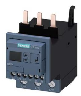
Stromüberwachungsrelais für IO-Link, anbaubar an Schütz, 3RT2, Baugröße S2 Schein-/Wirkstromüberwachung 8-80 A, 20-400 Hz, 3-phasig Versorgungsspannung DC 24 V 1 Wechsler Überwachung auf Stromüber- und Unterschreitung Stromasymetrie Phasenausfall, Drahtbruch Phasenfolge, Fehlerstrom Blockierstrom, Schaltspiel- und Betriebsstundenzähler Warn- und Alarmschwellen AUTO- oder HANDRESET Anlaufverzögerung 0-9999,9 s Ausschaltverzögerung 0-9999,9 s Wiedereinschaltverz. 0-300 min Schraubanschlusstechnik
