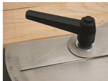
Die Schenkel werden durch einen großen Klemmhebel mit Ausrastknopf stabil fixiert.
