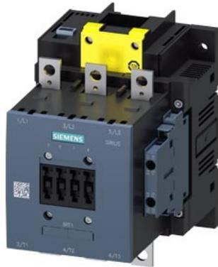
Leistungsschütz, AC-3e/AC-3 115 A, 55 kW / 400 V, AC (50-60 Hz) / DC Uc: 200-277 V x (0,8-1,1) F-SPS Eingang 24 V DC 3-polig, Hilfskontakte 2 S + 2 Ö Antrieb: elektronisch Hauptstr.: Schiene Steuer- und Hilfsstromkreis: Schraubanschluss
