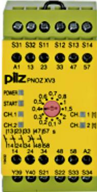
Sicherheitsschaltgerät (standalone), Eingänge: 1/2-kanalige Beschaltung mit/ohne Querschlusserkennung, Ausgänge: 3 S, 2 Sz, UB = 24 V DC, Breite: 45 mm, Schraubklemmen integriert, Überwachung von Not-Halt, Schutztüren, mit 2 rückfallverzögerten Kontakten, Verzögerungszeit einstellbar in 12 Stufen von 0,1 - 3 s.
