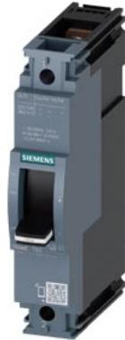
Leistungsschalter 3VA1 IEC Frame 160 Schaltvermögenklasse N Icu=25kA @ 240V 1-polig, Anlagenschutz TM210, FTFM, In=125A Überlastschutz Ir=125A fest eingestellt Kurzschlusschutz li=10 x In Schraubenflachanschluss
