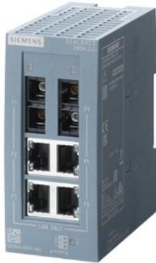
SCALANCE XB004-2LD unmanaged Industrial Ethernet Switch für 10/100 Mbit/s; zum Aufbau von kleinen Stern- und Linienstrukturen; LED-Diagnose, IP20, AC/DC 24V Spannungsversorgung, mit 4x 10/100 Mbit/s Twisted Pair Ports mit RJ45-Buchsen; 2 x 100 Mbit/s Single-Mode Glas LWL-Port mit SC-Buchse; Handbuch als Download verfügbar .
