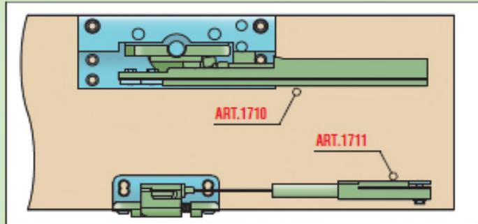
Um eine korrekte Funktion sicherzustellen, ohne dass sich die Türen ruckartig bewegen, müssen der obere und untere Dämpfer gleichzeitig auslösen.
