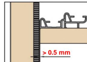
Um eine einwandfreie Funktion zu gewährleisten muss mind. 0.5 mm Luft zwischen Bürstendichtung und Seitenwand sichergestellt sein.
