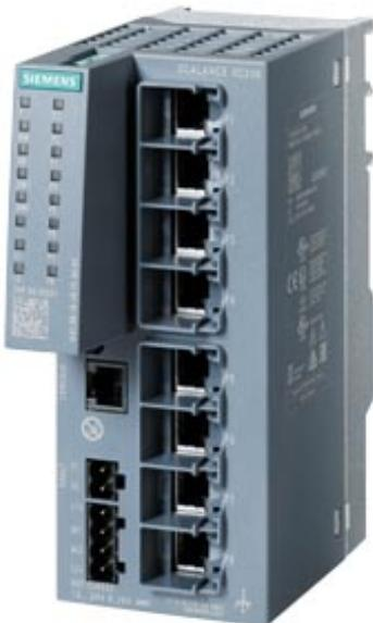
SIPLUS NET SCALANCE XC208 -40...+70°C mit Conformal Coating based on 6GK5208-0BA00-2AC2 . manageable Layer 2 IE Switch; 8x 10/100 Mbit/s RJ45-Ports; 1x Konsolen-Port; Diagnose-LED redundante Spannungsversorgung Temp.-Bereich -40°C bis +70°C; Montage: Hut-/S7-Profilschiene/Wand Redundanzfunktionen Office Features (RSTP, VLAN ...); PROFINET IO-Device Ethernet/IP-konform C-PLUG Schacht;
