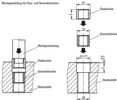
Einsetzen der Pass- und Gewindebuchse:
