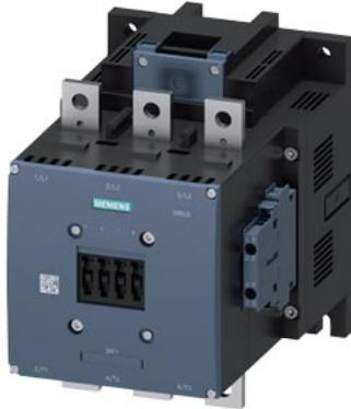
Leistungsschütz, AC-3e/AC-3 500 A, 250 kW / 400 V AC (50-60 Hz) / DC U<sub>c</sub>: 440-480 V 3-polig, Hilfskontakte 2 S + 2 Ö Antrieb: konventionell Hauptstr.: Schiene Steuer- und Hilfsstromkreis: Schraubanschluss
