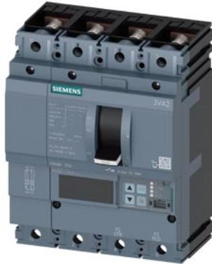
Leistungsschalter 3VA2 IEC Frame 250 Schaltvermögenklasse H Icu=85kA @ 415V 4-polig, Anlagenschutz ETU550, LSI, In=160A Überlastschutz Ir=63A...160A Kurzschlusschutz Isd=0,6..10x In, li=1,5..12x In N-Leiterschutz einstellbar (OFF, bis 160%) Schraubenflanschanschluss
