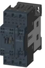
CONTACTOR, AC-3, 4KW/400V, 1NO+1NC, AC 24V 50/60HZ, 3-POLE, SZ S0 SPRING-LOADED TERMINAL
