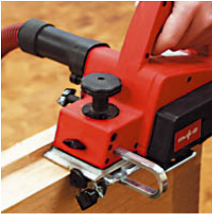
Nachfalzen einer Tür mit dem MHU 82.
