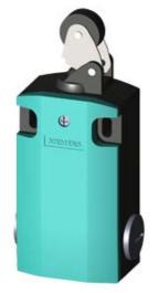
SIRIUS POSITIONSSCHALTER 3SE5162, METALLGEHAUSE XL,56MM BREIT MIT ROLLENHEBEL, AUS METALL UND KUNSTSTOFFROLLE 22MM GERAETEANSCHLUSS 3X(M20X1,5), 2X (1S/10E) SPRUNGSCHALTGLIEDER; IP66/IP67
