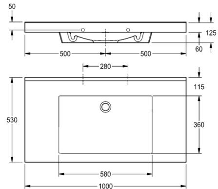
QUADRO Einzelwaschtisch aus kunstharzgebundenem Mineralwerkstoff MIRANIT, mit porenfreier, glatter Oberfläche (temperaturbeständig bis 80 °C), Farbton Alpinweiß. Mit einer nahtlos eingeformten, rechteckigen Mulde, ohne Überlauf, ohne Armaturenbohrung. Befestigung an Beckenrückwand. Dreiseitige Schürze. Hintere Schwallkante, inklusive Befestigungsmaterial.
