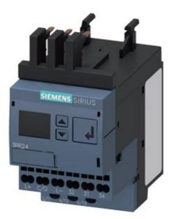
Stromüberwachungsrelais für IO-Link, anbaubar an Schütz 3RT2, Baugröße S00 Schein-/Wirkstromüberwachung 1,6-16 A, 20-400 Hz, 3-phasig Versorgungsspannung DC 24 V 1 Wechsler Überwachung auf Stromüber- und Unterschreitung Stromasymetrie Phasenausfall, Drahtbruch Phasenfolge, Fehlerstrom Blockierstrom, Schaltspiel- und Betriebsstundenzähler Warn- und Alarmschwellen AUTO- oder HANDRESET Anlaufverzögerung 0-9999,9 s Ausschaltverzögerung 0-9999,9 s Wiedereinschaltverz. 0-300 min Federzugtechnik
