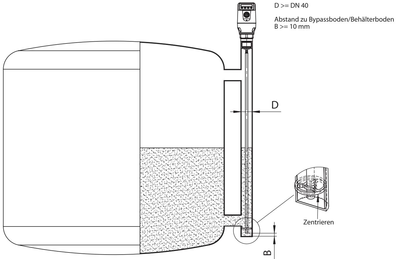
Einbau in einen metallischen Behälter
