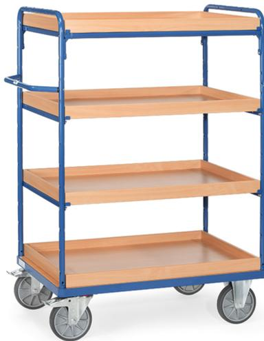
Baukasten-System: Aus Stahlrohr und Profilstahl geschweißt, pulverbeschichtet blau RAL 5007, Schraubkonstruktion. Stirnwände offen. 1 fester und 3 Einlegekästen aus Holzwerkstoffplatten, Oberfläche Buchendekor. Einlegekästen variabel einsetzbar, Teilung 100 mm. Tragkraft pro Einlegekasten 120 kg. 2 Lenk- und 2 Bockrollen, TPE-Bereifung, Naben mit Rillenkugellager. Feststeller an den Lenkrollen, gemäß der Europäischen Norm EN 1757-3 (Sicherheit von Plattformwagen).
