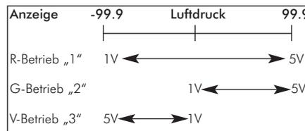
(Werkseitig ist der Analogausgang des DRSEC 1 (ES) auf V-Betrieb „3“ voreingestellt. Beim DRSEC 10 (ES) ist nur G-Betrieb „2“ möglich. Für alle anderen Druckmesser ist V-Betrieb „1“ voreingestellt.)
