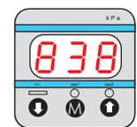
Nach Drücken der M-Taste für mehr als 1 Sekunde schaltet das Gerät zurück in den Arbeitszustand.
