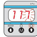
Für den dargestellten Fensterdiskriminatorbetrieb muss diese Ziffer mit den **1**/**1**-Tasten auf „7“ gesetzt werden.
