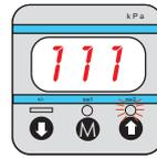
Nach kurzem Drücken der **M**- Taste blinkt die LED „Ausgang 2“ unter der 1. Ziffer.
