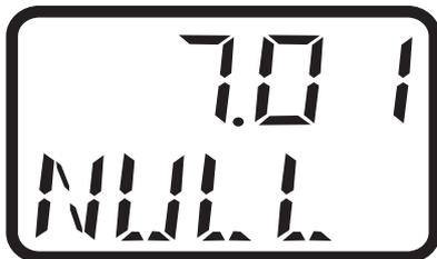
Der berechnete Nullpunkt der Messkette wird angezeigt.
