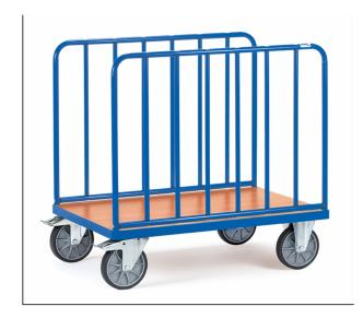
Ensemble mécano-soudé, revêtement époxy bleu RAL 5007, plateau en mélaminé surface effet hêtre, ridelles latérales avec barres verticales distantes de 130 mm, hauteur des ridelles 750 mm. 2 roues pivotantes et 2 roues fixes à bandage TPE, moyeu à roulement à billes central. Freins sur roues pivotantes conformément à la Norme 1757-3 (Sécurité des chariots de manutention).
