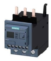
Stromüberwachungsrelais für IO-Link, anbaubar an Schütz, 3RT2, Baugröße S2 Schein-/Wirkstromüberwachung 8-80 A, 20-400 Hz, 3-phasig Versorgungsspannung DC 24 V 1 Wechsler Überwachung auf Stromüber- und Unterschreitung Stromasymetrie Phasenausfall, Drahtbruch Phasenfolge, Fehlerstrom Blockierstrom, Schaltspiel- und Betriebsstundenzähler Warn- und Alarmschwellen AUTO- oder HANDRESET Anlaufverzögerung 0-9999,9 s Ausschaltverzögerung 0-9999,9 s Wiedereinschaltverz. 0-300 min Schraubanschlusstechnik
