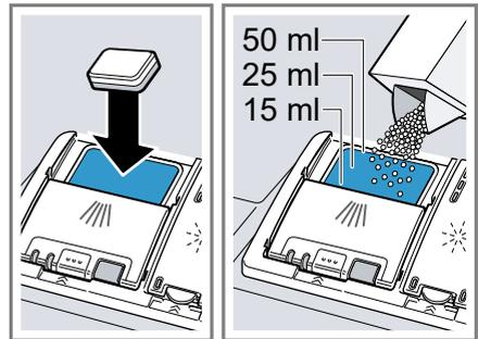
Wenn Sie Tabs verwenden, genügt eine Tablette. Tabs quer einlegen. Wenn Sie Pulverreiniger oder Flüssigreiniger verwenden, beachten Sie die Dosierungshinweise des Herstellers und die Dosierungseinteilung der Reinigerkammer.
