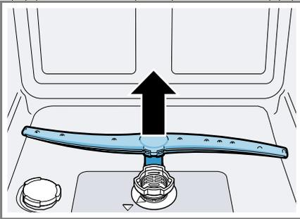
2. Unter fließendem Wasser die Austrittsdüsen des Sprüharms auf Verstopfungen prüfen und gegebenenfalls Fremdkörper entfernen.
