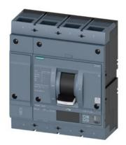
Leistungsschalter 3VA2 IEC Frame 1000 Schaltvermögenklasse M Icu=55kA @ 415V 4-polig, Anlagenschutz ETU860, LSIG, In=800A Überlastschutz Ir=320A...800A Kurzschlussschutz Isd=0,6..10x In, Ii=1,5..10x In N-Leiterschutz einstellbar (OFF, bis 160%) Erdschlussschutz, abschaltbar Ig=0,2...1 x In= tg=0,05-0,8s Schraubenflachanschluss
