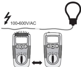
Wird Wechselspannung detektiert, so leuchtet die NCV-Anzeige (6) auf.
