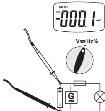
Für Wechselspannungsmessungen drücken Sie die Taste „MODE“ (3) um in den AC-Bereich umzuschalten. Eine erneute Betätigung schaltet wieder zurück usw.
