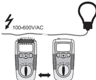
Lorsque l'appareil détecte une tension alternative, l'indicateur NCV (6) s'allume.
