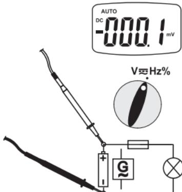
Voor wisselspanningsmetingen drukt u op de toets „MODE“ (3) om naar het AC-bereik om te schakelen. Door nogmaals op de knop te drukken, wordt weer teruggeschakeld, etc.
