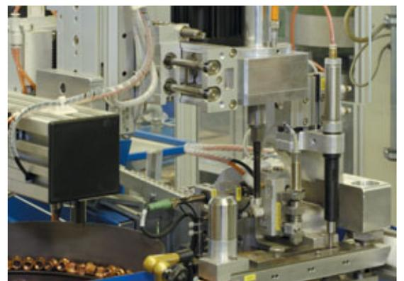
Automatische Verarbeitung von HELICOIL® plus M 8 screwlock mit Vibrationsvereinzelung.
