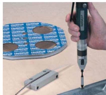
Einbau des HELICOIL® plus
