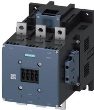
Leistungsschütz AC-1 690A / 690 V / 40°C 3-polig, Uc: 200-220 V AC(50-60 Hz) / DC Antrieb: konventionell Hilfskontakte 2 S + 2 Ö Hauptstr.: Schiene Steuer- und Hilfsstromkreis: Schraubanschluss
