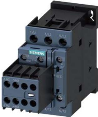
Leistungsschütz, AC-3e/AC-3, 25 A, 11 kW / 400 V, 3-polig, AC 230 V, 50/60 Hz, Hilfskontakte: 2 S + 2 Ö, Schraubanschluss, Baugröße: S0, Hilfsschalter lösbar
