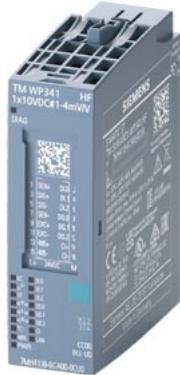
SIMATIC ET 200SP, TM SIWAREX WP341 HF, einkanalige Wägebaugruppe für Förderbandwaagen und Schüttstrommesser mit analogen Wägezellen / Dehnungsmesstreifen (Vollbrücken), 3xDI, 3xDQ, 1xRS485, 1xEthernet, 1xLC Wägezellen-Schnittstelle (1-4mV/V), passend für BU-Typ U0, Verpackungsmenge: 1 Stück, Detaillierte Wägezellendiagnose mit digitalem Anschlusskasten SIWAREX DB (7MH5001-0AD20 oder 7MH5001-0AD01) möglich.
