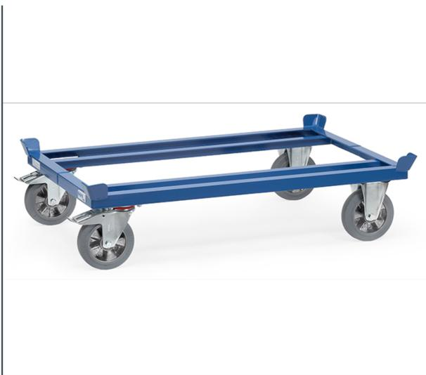
Für Flachpaletten und Gitterboxen. Robuste Winkelstahl-Schweißkonstruktion, mit 4 Fangecken, pulverbeschichtet, blau RAL 5007. 2 Lenk- und 2 Bockrollen, Elastic-Vollgummi-Bereifung, Naben mit Kugellager, blaugrau "spurlos", Feststeller an den Lenkrollen, gemäß der europäischen Norm EN 1757-3 (Sicherheit von Plattformwagen). Geringer Rollwiderstand, elastischer Lauf, keine Fahrgeräusche.
