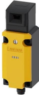
Sicherheits-Positionsschalter mit getrenntem Betätiger Metallgehäuse, 40 mm nach DIN EN 50041 mit M12-Stecker, 5-polig, fest mit 2 LED, gelb/grün DC 24 V 5 Anfahrrichtungen Pin-Belegung: Pin1=21, Pin2=22 Pin3=14 und LED grün, Pin4=13 und LED gelb, Pin 5=Masse LED der dazu passende getrennte Betätiger 3SE5000-0AV0. muss separat bestellt werden
