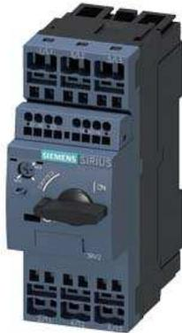
Leistungsschalter Baugröße S0 für den Motorschutz, CLASS 10 A-Auslöser 13...20 A N-Auslöser 260 A Federzuganschluss Standardschaltvermögen mit querliegenden Hilfsschalter 1S+1Ö
