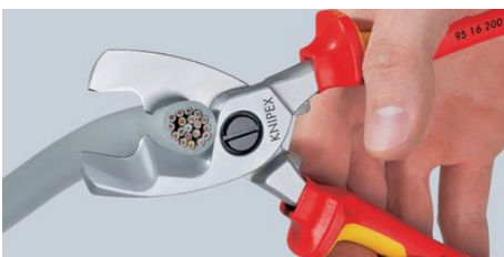
Cięcie ostateczne: jeżeli do przecięcia kabla wymagana jest większa siła, można użyć ostrza znajdującego się w pobliżu złącza nożyc. Cięcie wstępne za pomocą ostrza przedniego - cięcie ostateczne za pomocą ostrza tylnego
