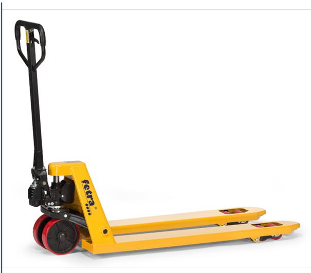
Rahmen und Gabeln in verwindungsfreier Schalenbauweise, gelb pulverbeschichtet. Hydraulische Handpumpe wartungsfrei gelagert. Stabile Stahlrohrdeichsel mit Gegenlager für Schubbetrieb, pulverbeschichtet schwarz, Griff gummiummantelt. Bedienhebel für die Funktionen: Heben - Fahren - Senken. Lenkeinschlag 2 x 100°. Kletterrollen an den Gabelspitzen. Berädung: Geringer Rollwiderstand, elastischer Lauf. Gut auf empfindlichen Böden, nicht kreidend = spurlos. Geringe Fahrgeräusche. 2 Jahre Garantie
