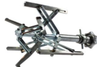
ISEC Innenzentrier-Vorrichtung für Flansche und Rohrbögen, 120-315 mm.
