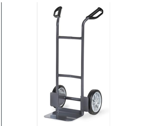
Tous les éléments sont conducteurs d'électricité. Ensemble mécano-soudé en tube et tôle d'acier, revêtement époxy gris foncé RAL 7015. ESD-poignées de sécurité en plastique dur avec arceaux de sécurité. Bavette en tôle d'acier vissé et remplaçable. Roues à bandage ESD-caoutchouc, moyeu à roulement à rouleaux. Tablier cintré permettant d'embarquer des éléments ronds tels que rouleaux, bidons, seaux etc.
