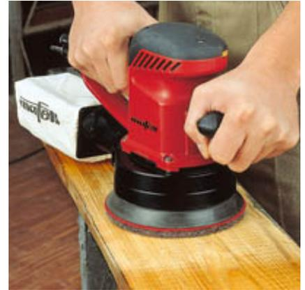
Das Schleifvlies P 100 bzw. P 280 (erhältlich als Sonderzubehör) wird zum Auffrischen von altem Holz oder für einen Lackzwischen Schliff eingesetzt.
