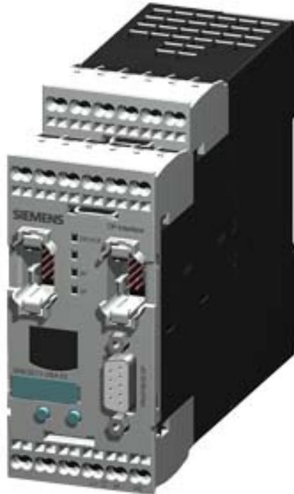
SIRIUS, Interface Modul DP-Interface, für modulares Sicherheitssystem 3RK3 PROFIBUS-DP-Schnittstelle 12 Mbit/s, RS 485 45 mm Baubreite Federzugklemme parametrierbar über Safety ES ohne Verbindungskabel
