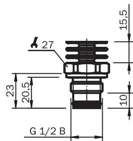
Gehäuse mit Rundsteckverbinder M12 x 1
