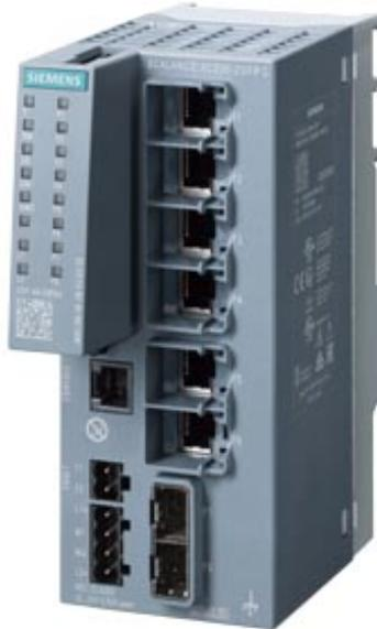
SCALANCE XC206-2SFP G managebarer Layer 2 IE Switch; IEC 62443-4-2 zertifiziert; 6x 10/100/1000 Mbit/s RJ45-Ports; 2x 1000 Mbit/s SFP; 1x Konsolen-Port; Diagnose-LED; redundante Spannungsversorgung; Temp.-Bereich -40°C bis +70°C; Montage: Hut-/S7-Profileschiene/Wand; Redundanzfunktionen; Office Features (RSTP, VLAN, ...); PROFINET IO-Device; Ethernet/IP-konform; C-PLUG Schacht;
