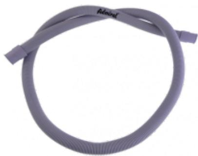
Spiral-Ablaufschlauch für Wasch- und Spülmaschine mit Anschlussmuffen 19/22 mm. Besonders geeignet für Einbaugeräte, da der Schlauch beim Einschieben nicht abknicken kann. Ablauf ohne Druck. Beständig gegen Waschmittel, Spülmittel, Hypochloride. Klemmbogen separat bestellbar.
