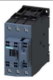
SCHUETZ FUER BAHN, AC-3, 22KW/400V, 1S+10E, DC110V, 0,7...1,25\*US, M. VARISTOR, 3POL, BGR. S2, FEDERZUGANSCHLUSS
