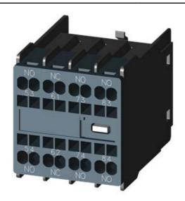
AUX.SWITCH BLOCK,FRONT,3NO+1NC, CURR.PATH: 1NO, 1NC, 1NO, 1NO, FOR CONTACTOR RELAYS, SZ S00, SPRING-LOADED TERMINAL 53 / 54,61 / 62,73 /74,83 / 84
