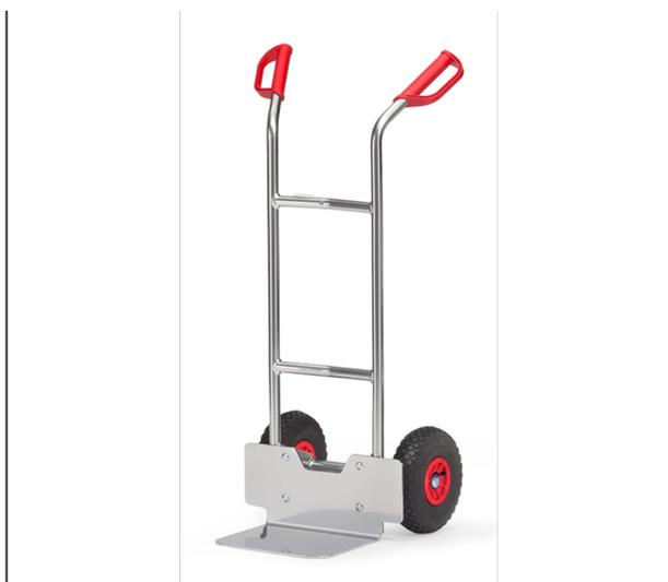
Ensemble mécano-soudé en aluminium. Soigneusement soudé sans revêtement, léger et maniable. Poignées de sécurité en plastique dur. Tablier cintré permettant d'embarquer des éléments ronds tels que rouleaux, bidons, seaux etc. Bavette en tôle d'alu à boulonner et remplaçable. Roues gonflables, moyeu à roulement à rouleaux. Livré avec bavette démontée.
